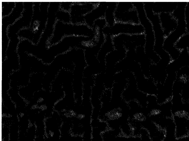
Рис. 20. Микрофотография конвективных валов, образующихся при синтезе сэндвичевой структуры CdSe на стекле на воздухе 104 Мощность лазера 1 Вт; типичный масштаб ячеек \sim 10 мкм; отношение ширины к толщине вала \sim 50
